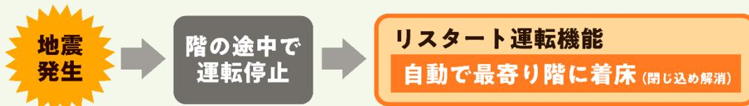
地震時管制運転により最寄り階へ着床する前に何らかの要因で安全装置が作動し、エレベーターが停止しても、その後、安全装置が正規の状態に復帰したことが確認できた場合には、かごを最寄り階に着床させて戸を開くことにより、閉じ込めを解消する機能
