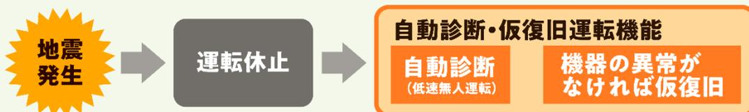
地震時管制運転により、かごを最寄り階に着床させ、運転を停止した後にエレベーター機器の破損等の危険性を機械的に診断し、仮復旧させる機能
